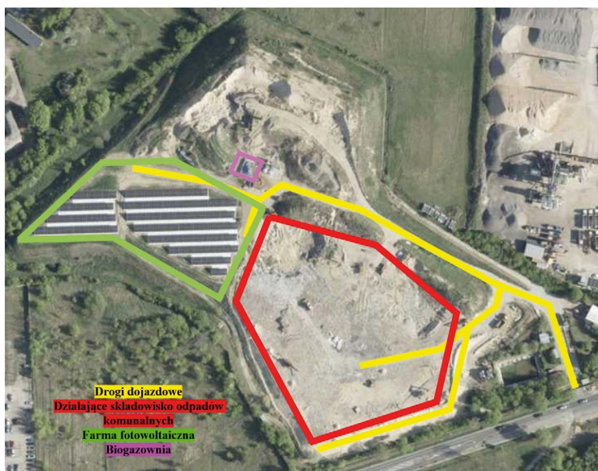
Rys. 2. Widok działającego składowiska odpadów komunalnych w Zakroczymiu z instalacją fotowoltaiczną w części zrewitalizowanej (opracowanie własne)
